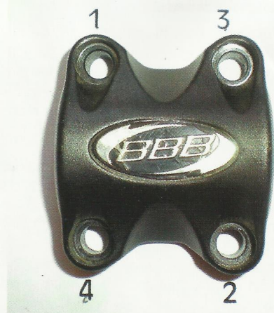
Ordre de serrage des vis de capot.
